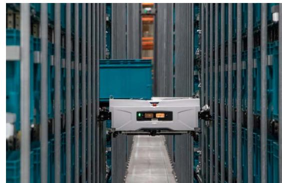
\*AMR: Autonomous Mobile Robot (自律走行搬送ロボット)
